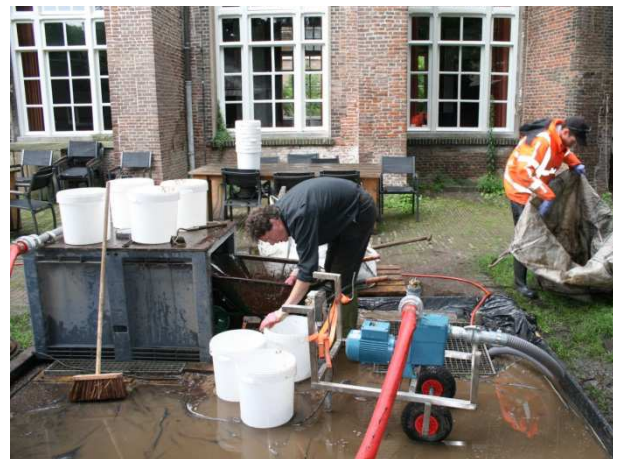
De zeefinstallatie: links het hondenhok, daar half in een zeefkruitwagen. Op de voorgrond de pomp.
